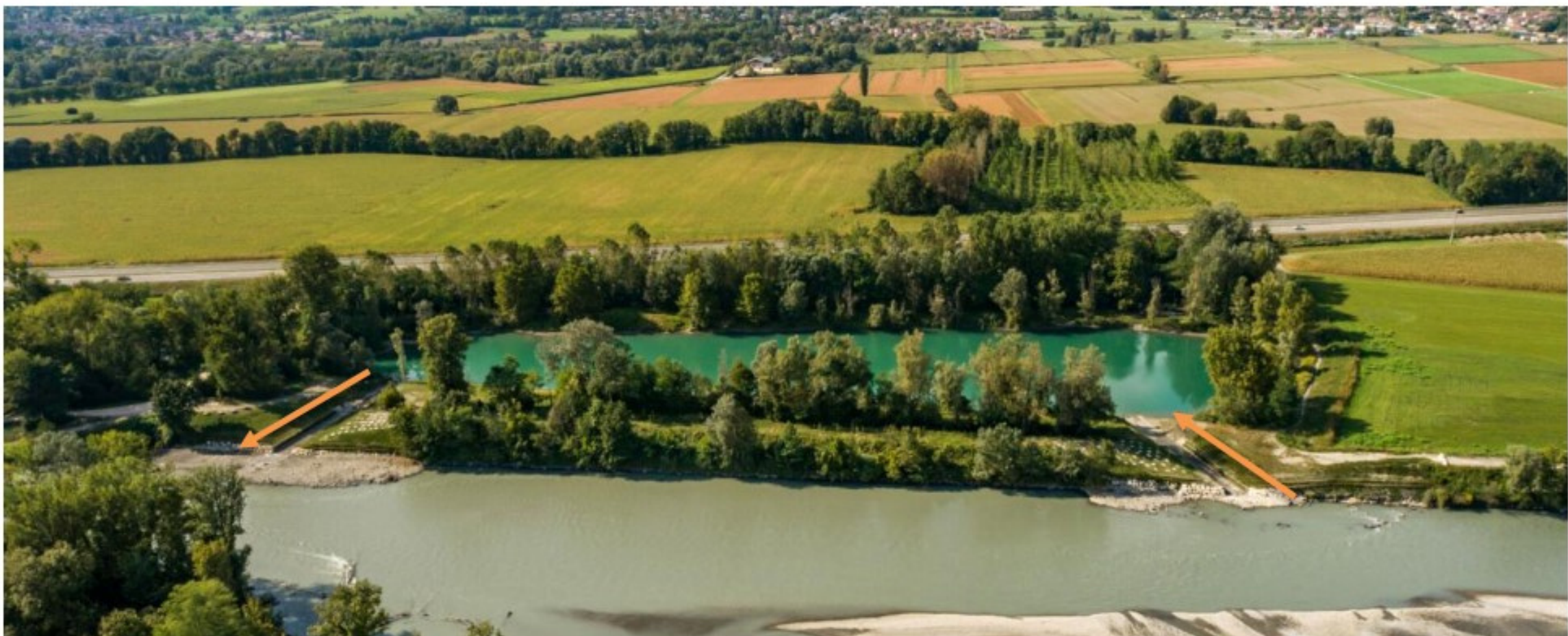
Image 18 : gravière reconnectée à l'Isère via un effacement de digue.
