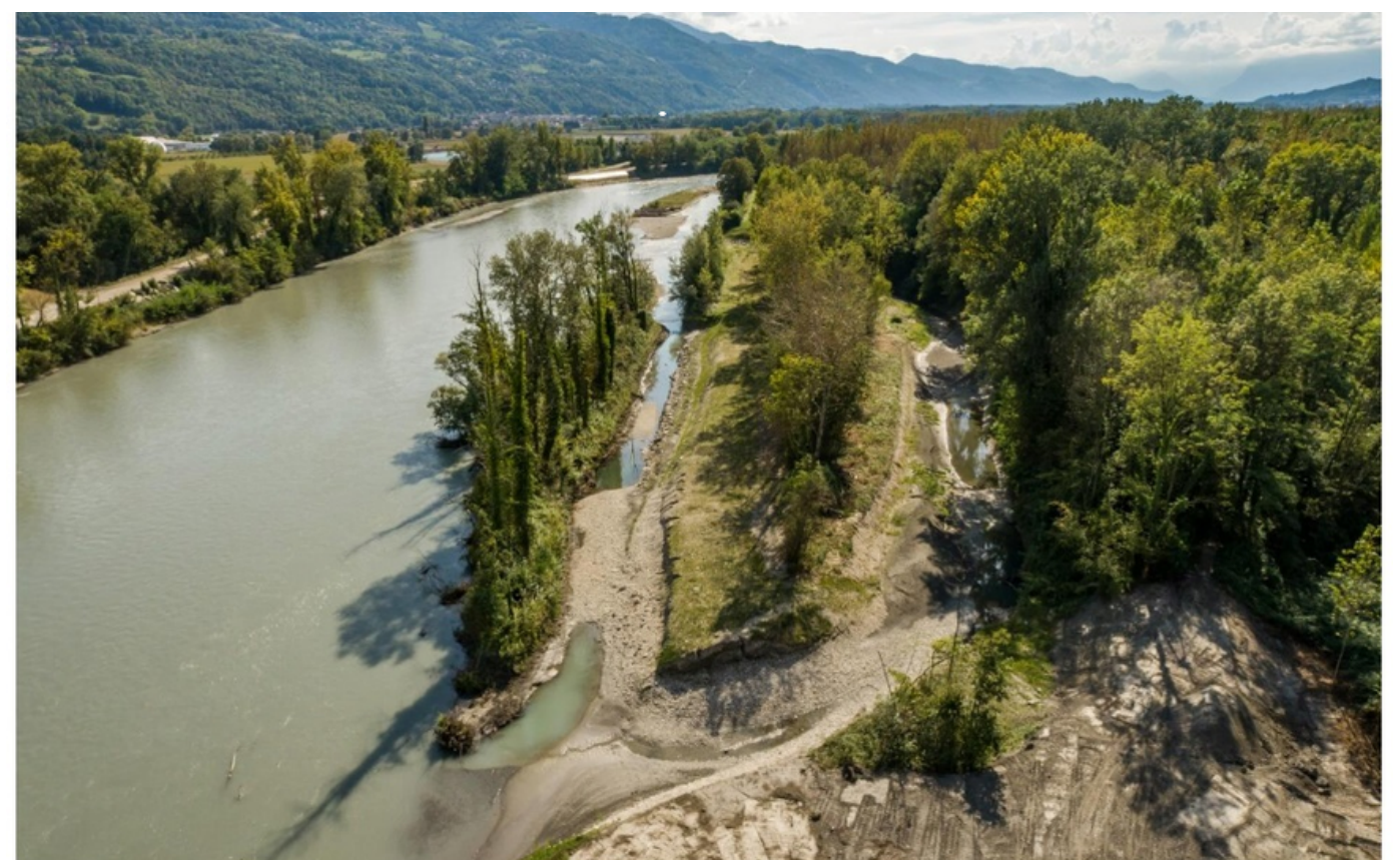
Effacement de digues et création d'annexes fluviale dans le lit mineur en basse eau.
