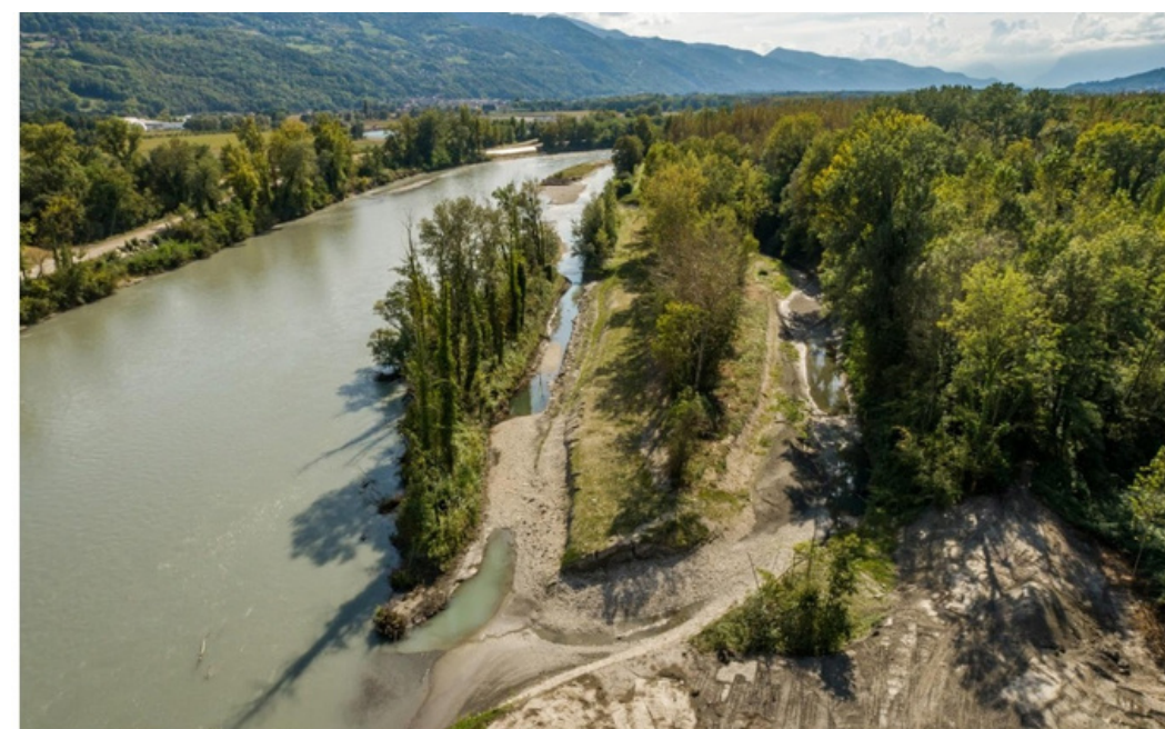
Effacement de digues et création d'annexes fluviale dans le lit mineur en basse eau.
